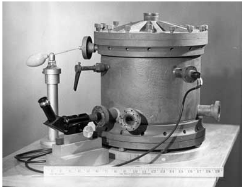
Obr. 5: Millikanův originální přístroj na měření náboje elektronu [5]
