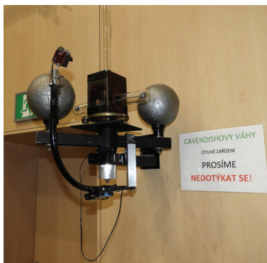
Obr. 1: Cavendishovy váhy v posluchárně T2 (budova MFF UK, V Holešovičkách 2, Praha 8)
