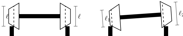
(a) Přímá dráha. U obou kol jsou stejné velké průřezy l
