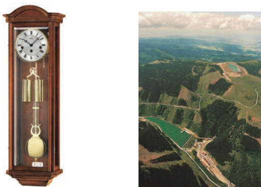
Obr. 1: Vlevo: Historické hodiny zvané pendlovky využívají závaží k uchování mechanické energie. Vpravo: Vodní nádrž přečerpávací elektrárny Dlouhé stráně slouží jako akumulátor mechanické energie (na kopci vpravo nahoře).
