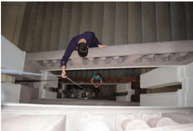
Obr. 1: Pevnost Břehyard: měření atmosférického tlaku vodním sloupcem.
