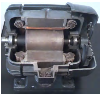
Obr. 3: Řez Teslovým dvoufázovým motorem
